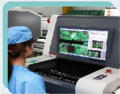
AOI检测 杜绝虚焊漏焊
