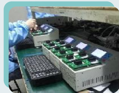
在线烧录 杜绝静电
