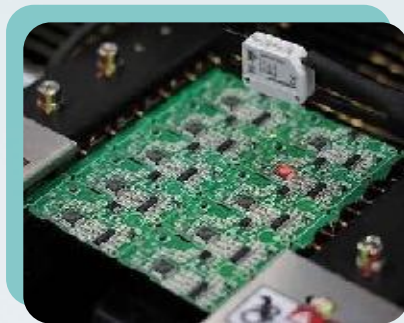
ICT在线测试 杜绝开路短路
