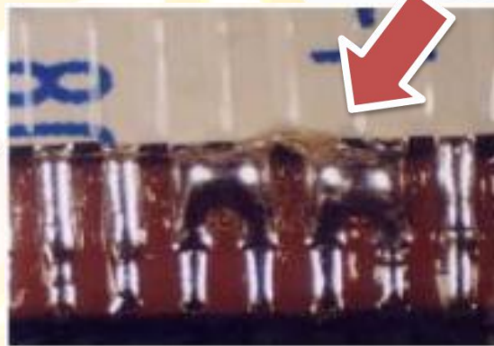
桥接 (连焊、短路)
