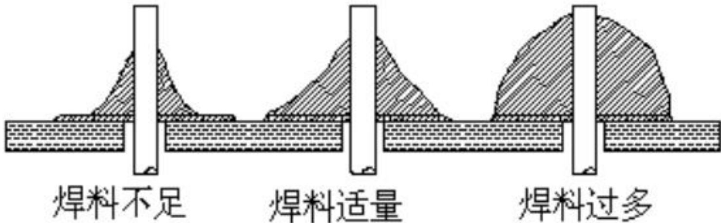
焊盘、焊锡量标准示意图
